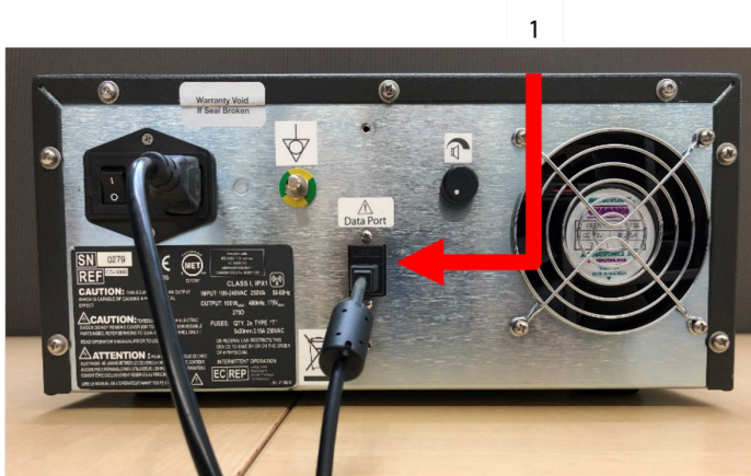
Εικόνα 12: Πίσω ταμπλό της γεννήτριας RF AtriCure CS-3000 με θύρα δεδομένων (USB ή σειριακή) (Εικόνα μόνο για αναφορά)
