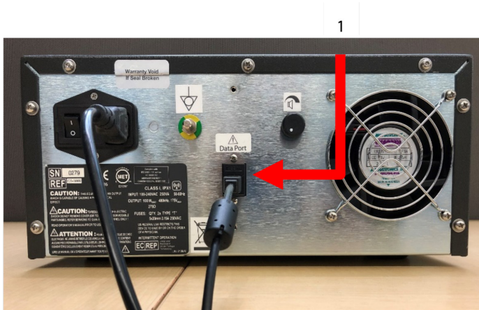
Figur 12: Bagpanel på AtriCure CS-3000 RF-generator med dataport (USB eller serial) (billede kun til reference)
