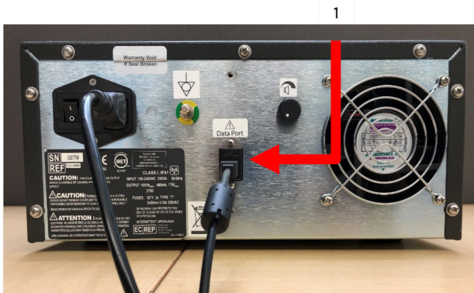
Figura 12: Pannello posteriore del generatore a RF AtriCure CS-3000 con porta dati (USB o seriale) (Immagine solo per riferimento)
