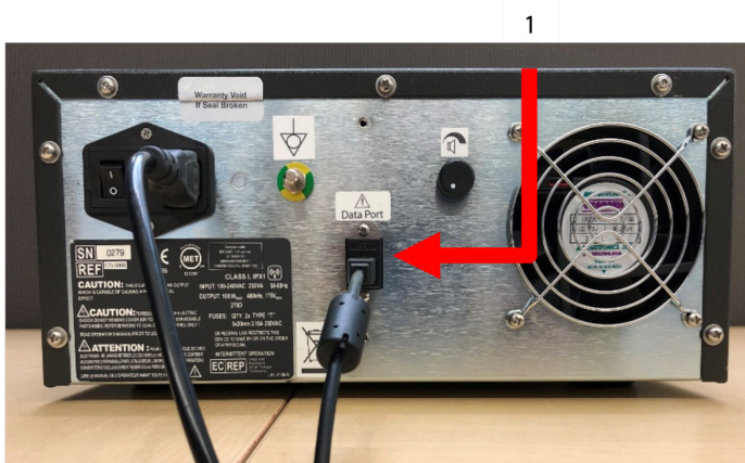
Joonis 12. AtriCure CS-3000 RF-generaatori tagapaneel andmesidepordiga (USB- või jadaport) (pilt on illustratiivne)
