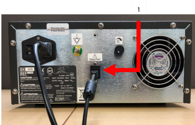
Abbildung 12: Rückwand des AtriCure CS-3000 HF Generators mit Datenanschluss (USB oder seriell) (Bild dient nur als Referenz)
