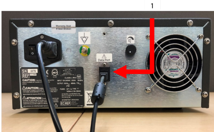
Figure 12 : Panneau arrière du générateur RF CS-3000 d'AtriCure avec Port de données (USB ou série) (Image pour référence uniquement)
