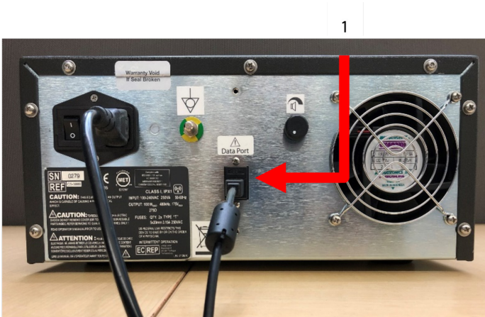
Figur 12: Bakpanel på AtriCure CS-3000 RF-generator med dataport (USB eller seriell) (bilde kun for referanse)
