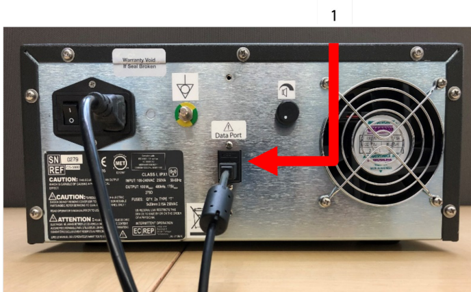
Obrázok 12: Zadný panel RF generátora AtriCure CS-3000 s dátovým portom (USB alebo sériovým) (obrázok len na referenčné účely)
