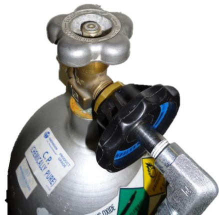
HÌNH 7: XOAY VAN NGƯỢC CHIỀU KIM ĐỒNG HỒ ĐỂ MỞ
