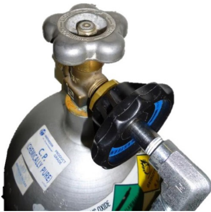
HÌNH 6: GẮN NÚM MÀU ĐEN VÀO ĐẦU NỐI REN
