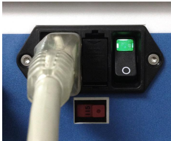
HÌNH 11: BẬT MÁY ĐỐT LẠNH ĐIỆN SINH LÝ BẰNG CÔNG TẮC
