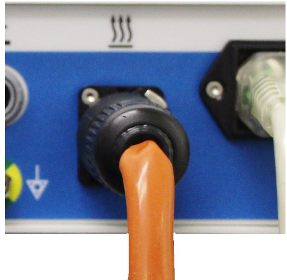
HÌNH 10: CẮM DÂY BĂNG TẦN NHIỆT VÀO Ổ CẮM
