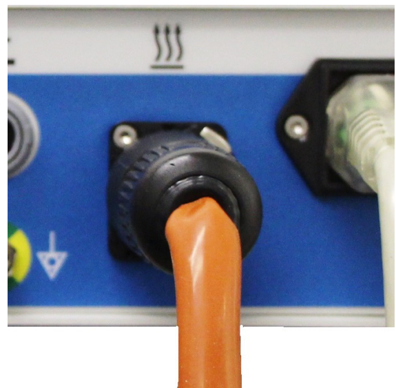
Afbeelding 9: Snoer van verwarmingsband op aansluiting aansluiten
