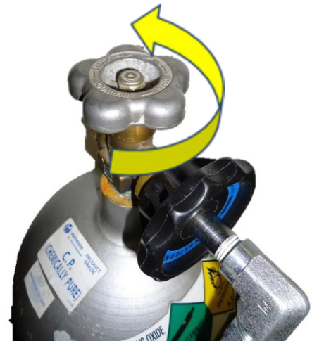
Afbeelding 6: De kraan linksom draaien om te openen
