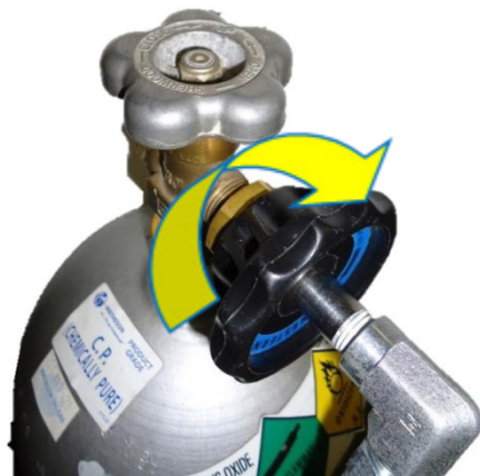
Afbeelding 5: De zwarte knop op de aansluiting met voerdraad plaatsen
