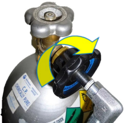
Figur 5: Fastgør det sorte greb i gevindforbindelsen
