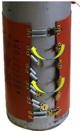
Figur 8: Fastgør alle spændefjederholdere
