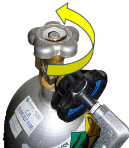
Figur 6: Drej ventilen mod uret for at åbne
