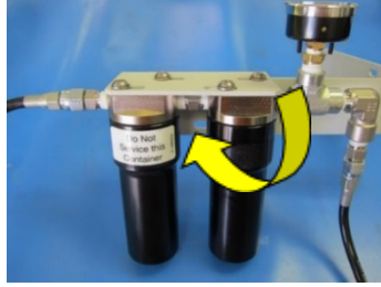
Şekil 23: Filtre Gövdesinin Sökülmesi
